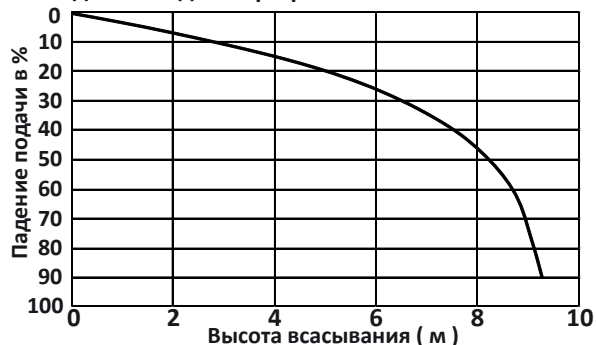
Падение подачи при разной высоте всасывания
